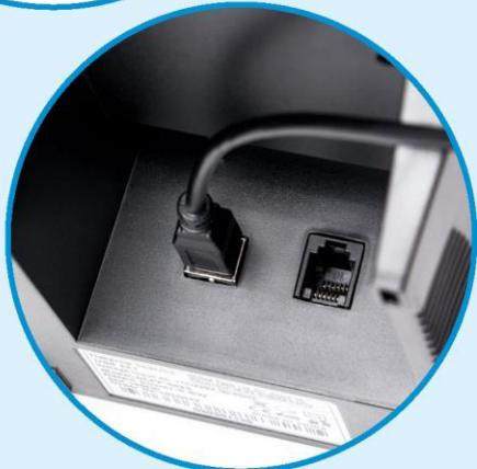
4) Zapojte napájací zdroj B do napájacej dierky na zadnej strane pokladničného systému A (vedľa USB konektora).
